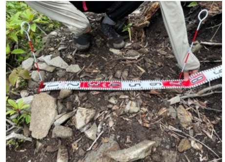
④ モニタリングポイント(洗掘高)
