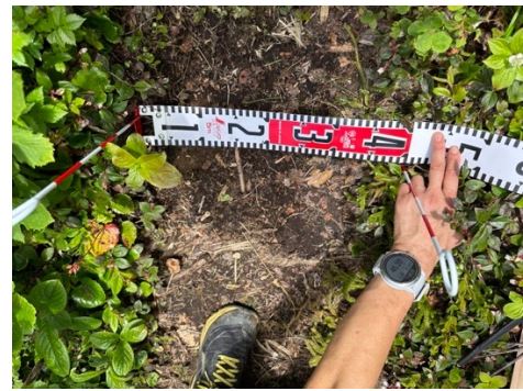
④ モニタリングポイント(洗掘高)
