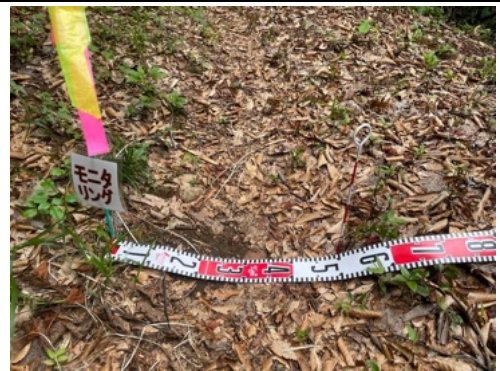
④ モニタリングポイント(洗掘高)
