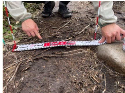
④ モニタリングポイント(洗掘高)
